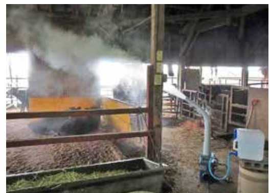
図4 牛飼養施設内での超音波噴霧器による微酸性次亜塩素酸水の噴霧
